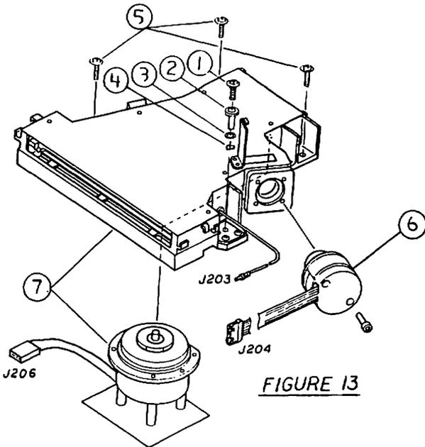
**LASERWRITER - LASER/SCANNER UNIT (Figure 13)**
