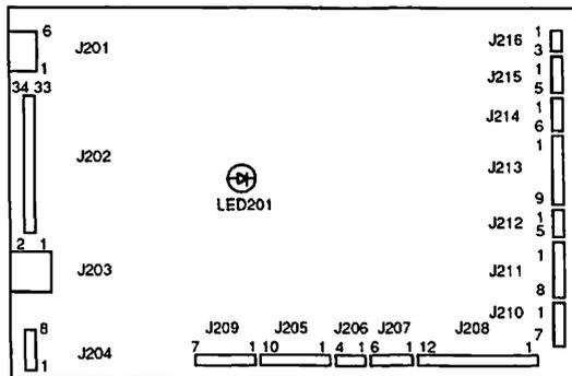
**CONNECTOR LOCATIONS ON THE DC CONTROLLER PCB**
